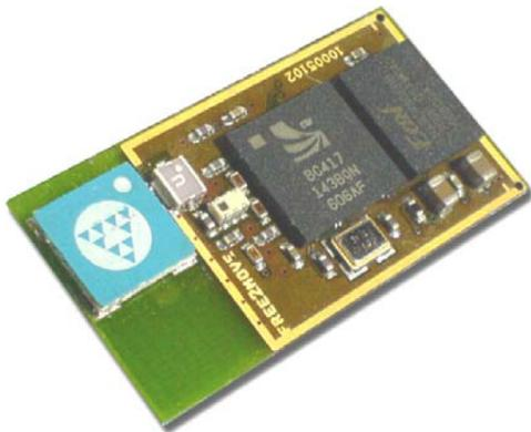
Le "F2M03GLA" est un module hybride subminiature Bluetooth™ v2+EDR pré-qualifié faible consommation. Doté d'une antenne intégrée et d'une puissance d'émission de +8 dBm, il dispose d'une portée maximale de l'ordre de 250 m en terrain dégagé.
