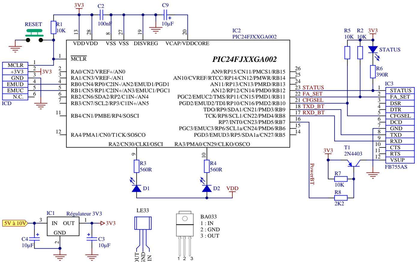
On utilise ici le module FIRMTECH FB755AS car il est adapté à un câblage sur plaquette.
