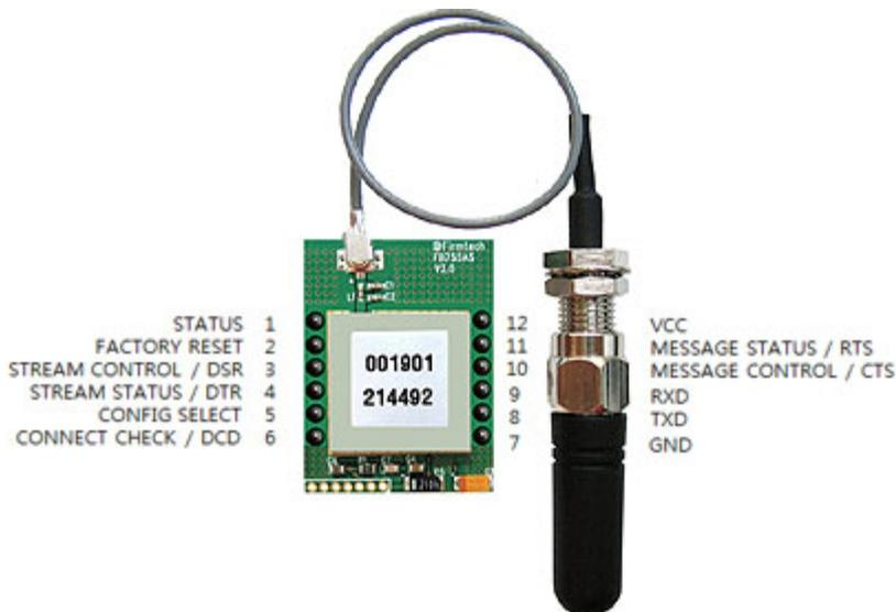
Le "FB755AS" de FIRMTECH est un module hybride DIL "OEM" subminiature Bluetooth™ Class 1 pré-qualifié faible consommation. Doté d'une antenne externe et d'une puissance d'émission de +12 dBm, il bénéficie d'une portée d'environ 100 mètres en terrain dégagé.
